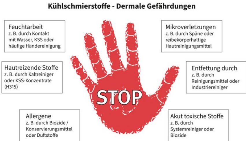
Abb. 1 Ursachen für Hautgefährdungen bei Tätigkeiten mit Kühlschmierstoffen
