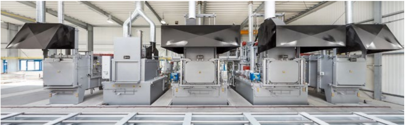
Abb. 35 Anlage, bestehend aus Anlassofen, Waschanlage, zwei Härteöfen und Anlassofen
