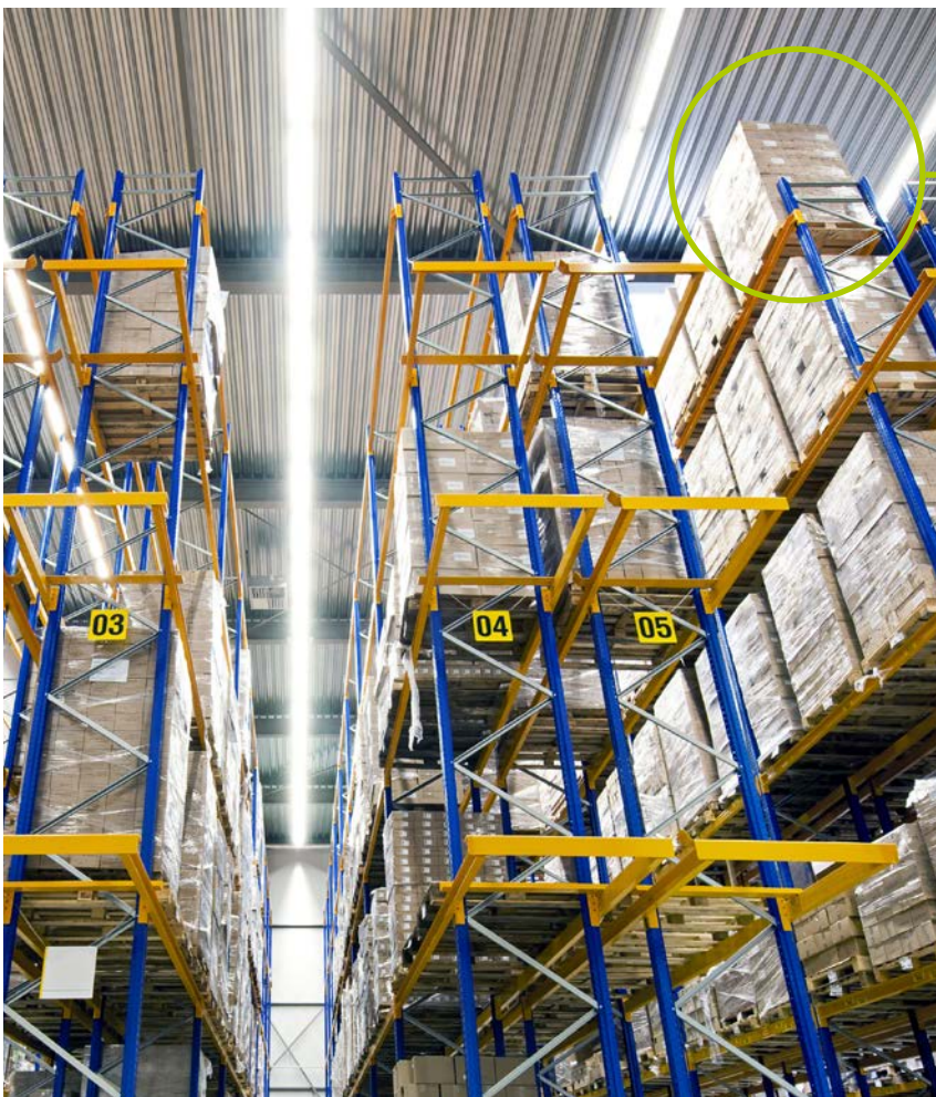
Abb. 110 Seitliche Sicherung gegen Herabfallen
