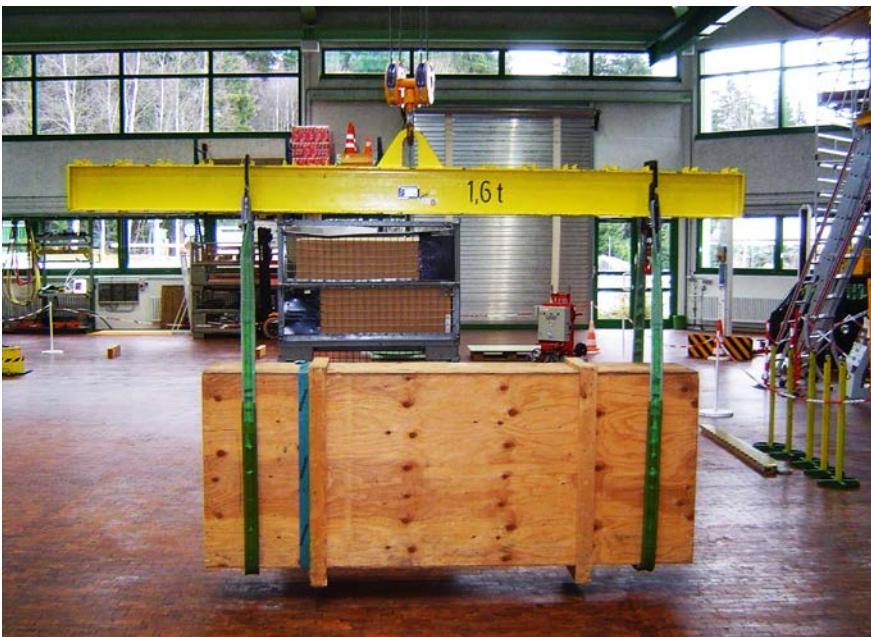
Abb. 105 Traverse mit angeschlagener Last
