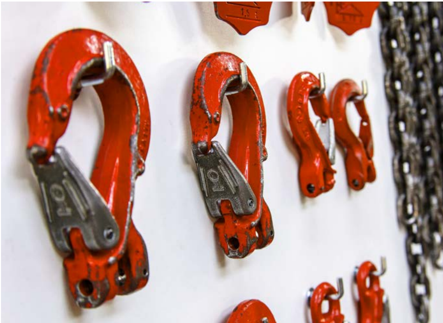
Abb. 108 Beispiel für Anschlagelemente
