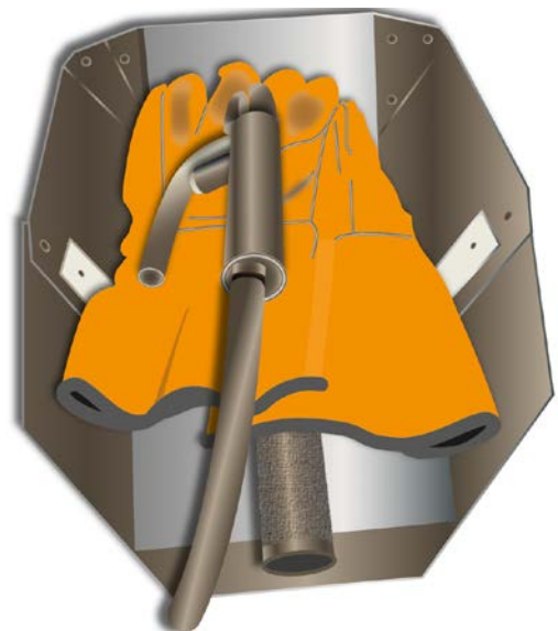
Abb. 58 Isolierte Ablage des Stabelektrodenhalters
