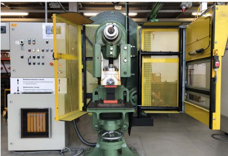
Abb. 39 Exzenterpresse mit steuernder trennender Schutzeinrichtung, feste Verkleidung, Fußschalter, Betriebsartenwahlschalter und Schaltsperre
