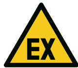
Abb. 10 Kennzeichnung für die Warnung vor explosionsfähiger Atmosphäre
