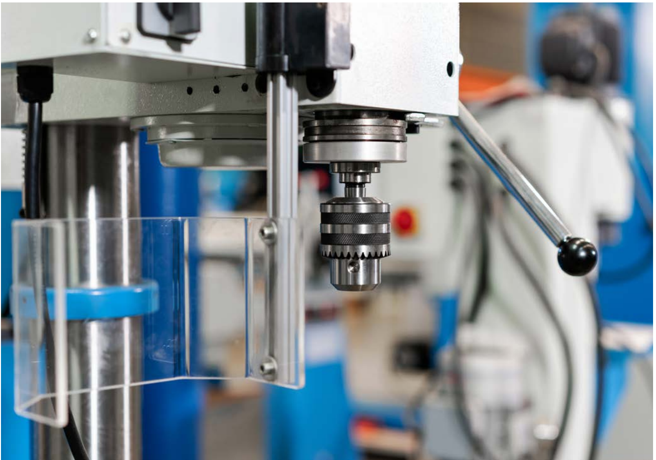
Abb. 27 Bohrspindel mit Abdeckung
