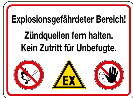
Abb. 25 Explosionsgefährdete Bereiche sind durch Warnzeichen und Verbotsschilder gekennzeichnet
