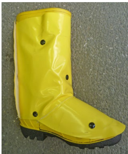
Abb. 42 Gamasche – Achtung, die Forderungen des Anhangs 7 sind nicht vollständig erfüllt – Abstände Gamasche-Sohle überschritten.
