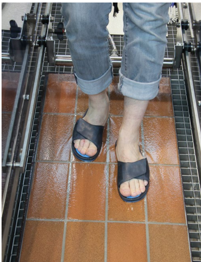
Abb. 56 Ergonomieprüfung von Badesandalen auf der Schiefen Ebene
