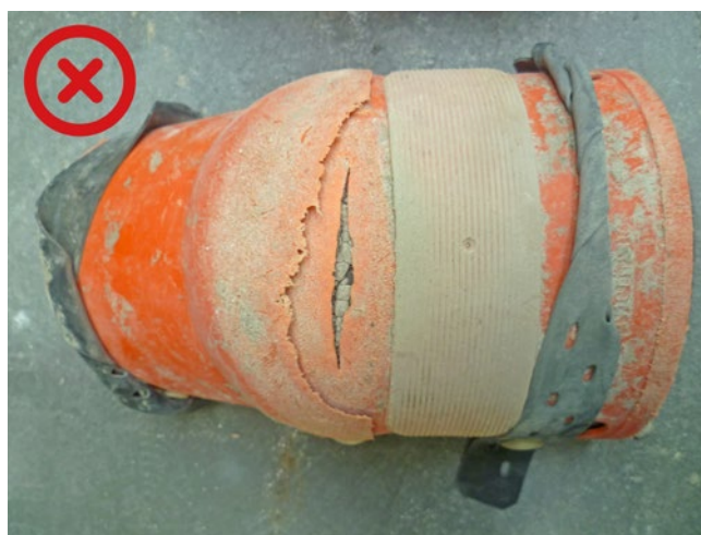
Abb. 83 Riss in sowie Abnutzung an Schale an Typ 1
