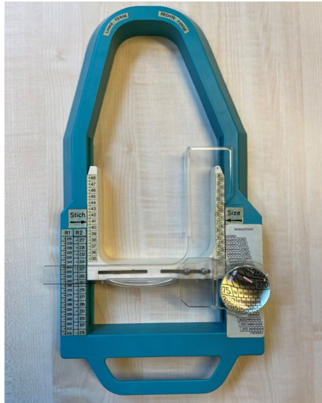
Abb. 6 Messsystem für die Bestimmung der Fußlänge und Fußbreite nebst Zuordnung zu den Größen
