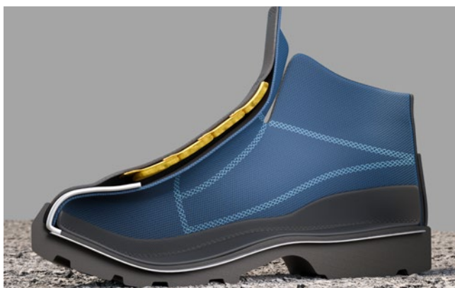
Abb. 22 Schnitt durch Sicherheitsschuh; Mittelfußschutz in Lasche integriert
