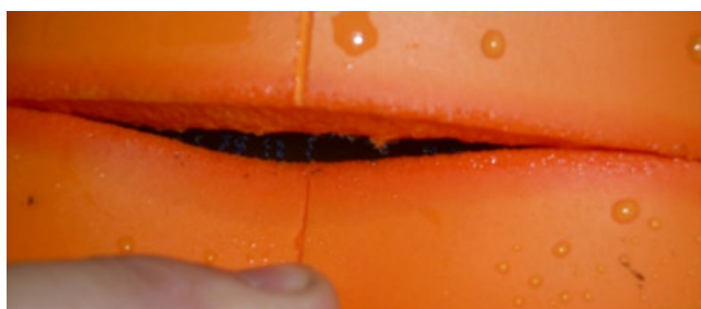
Abb. 41 S5 Stiefel, der unmittelbar hinter der Zehenkappe mit Wasserstrahl eingeschnitten wurde.
