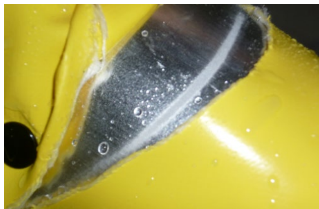
Abb. 43 Schnitt von Wasserstrahl innerhalb des Gamaschenbereichs nach o. g. Kriterien. Die metallische Einlage hat den Wasserstrahl zurückgehalten.
