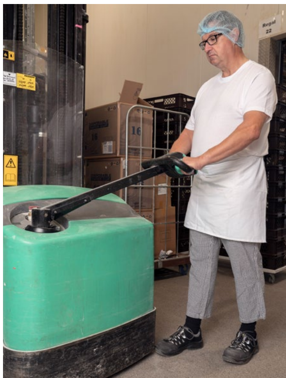
Abb. 17 Gefahr des Anstoßens/Anfahrens durch Hubwagen im Vorfußbereich
