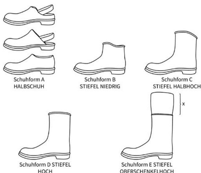
Abb. 3 Schuhformen gem. DIN EN ISO 20345ff
