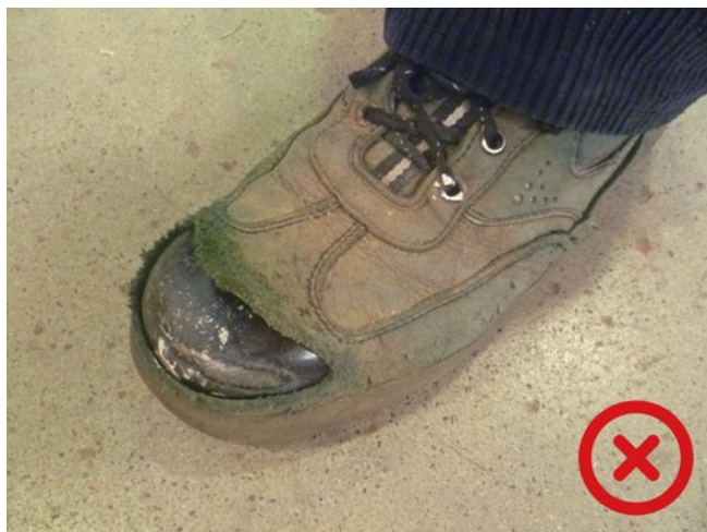
Abb. 10 Ablegereif, insbesondere da der Schuh im Vorderfußbereich zerschlissen ist, die Zehenschutzkappe liegt frei.
