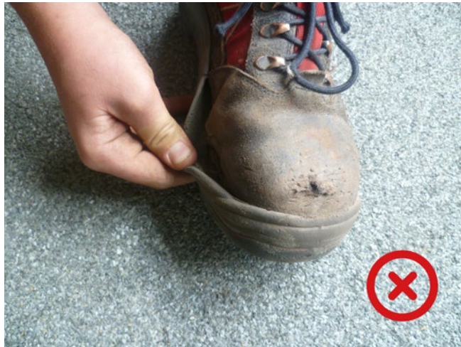
Abb. 9 Ablegereif, insbesondere da sich Sohle vom Schaft gelöst hat.
