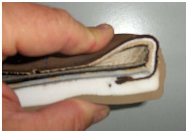
Abb. 18 Berufsschuh mit eingebauter Vorderkappe aus Kunststoff nur zur Formgebung – Zusammendrückbarkeit mit den Fingern verdeutlicht die fehlende Schutzfunktion
