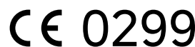
Abb. 2 CE-Kennzeichnung PSA der Kat. III mit vierstelliger Kennnummer der notifizierte Stelle – Beispielhafte Nennung der Kennnummer des IFA
