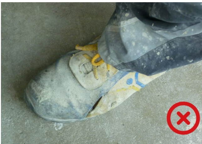
Abb. 8 Ablegereif, insbesondere wegen offener Naht.
