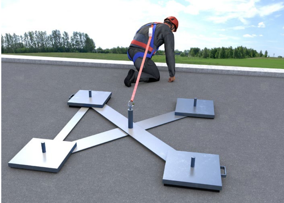
Abb. 64 Beispiel für eine durch Eigen- gewicht gehaltene Anschlag- einrichtung gemäß Typ E DIN EN 795
