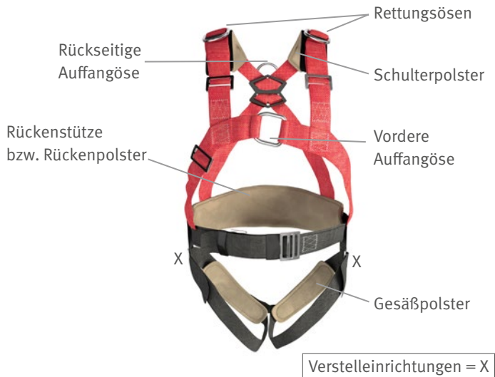
Abb. 9 Auffanggurt mit Rettungsösen
