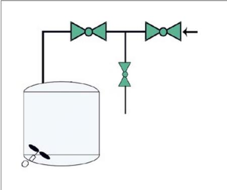
Abb. 17 Zwei Absperreinrichtungen mit Zwischenentspannung ins Freie
