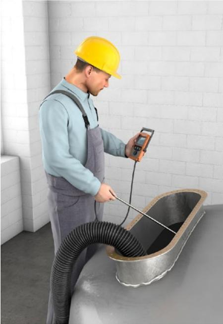
Abb. 19 Probenahme mittels Gasmessgerät
