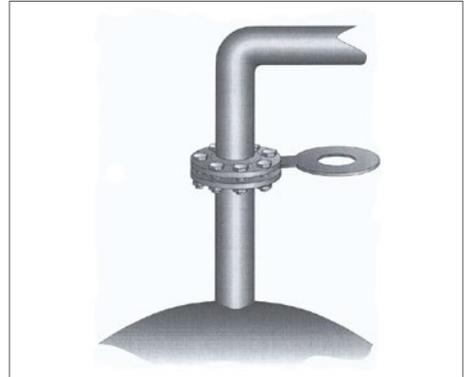
Abb. 18 Abtrennen mittels Steckscheibe
