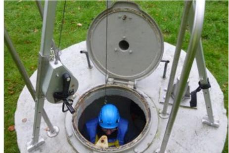
Abb. 23 Höhensicherungsgerät mit Rettungshubfunktion
