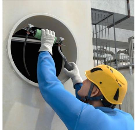
Abb. 20 Probenahme mittels Gassammelrohr
