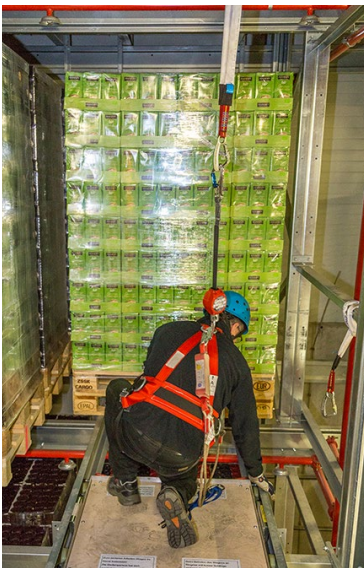
Abb. 21 Mit Höhensicherungsgerät über Kopf gesichert
