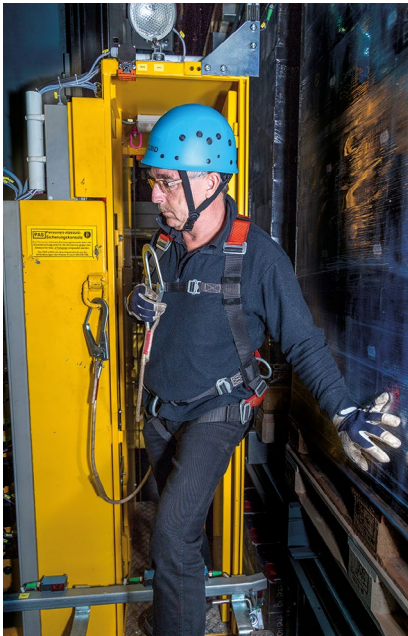
Abb. 7 Übergang vom Notsteuerstand zum Lastaufnahmemittel des Regalbediengerätes
