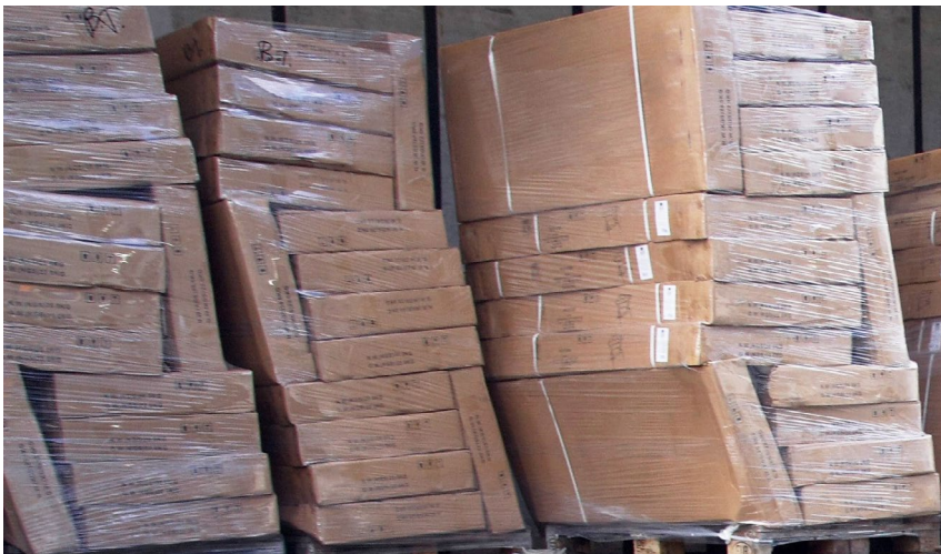
Abb. 1 Verschobene Ladung bei unzureichender Stretchesicherung
