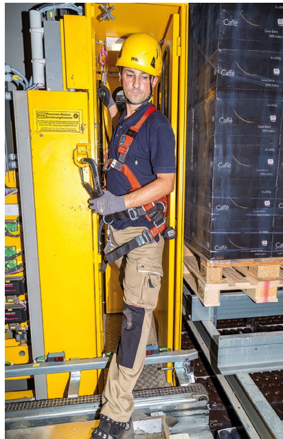
Abb. 13 Sichern am Anschlagpunkt auf der Lastaufnahmemittelseite vor dem Lösen der Sicherung im Steuerstand
