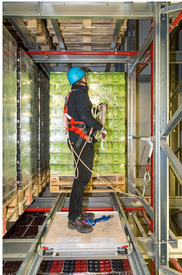
Abb. 20 Aus gesicherter Position heraus – Anschlag über Kopf
