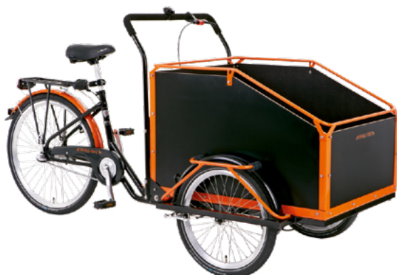
Abb. 8 Zweispurig, Laufradpaar vorne
