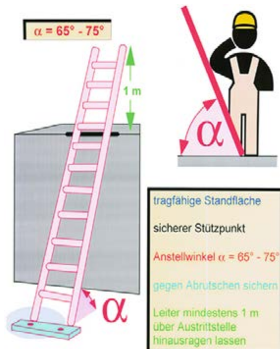
Abb. 4-2 Sichere Aufstellung einer Anlegeleiter
