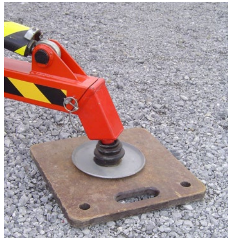
Bild 4-4 Positionierung der Stützfüße auf der Unterlegplatte
