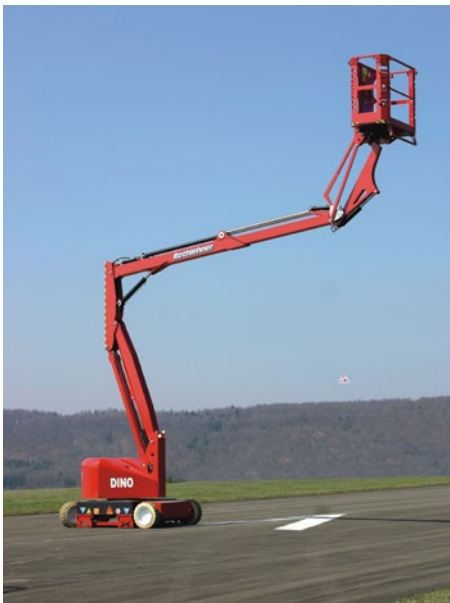
Bild 3-4 Gelenkteleskopbühne Typ 3B
