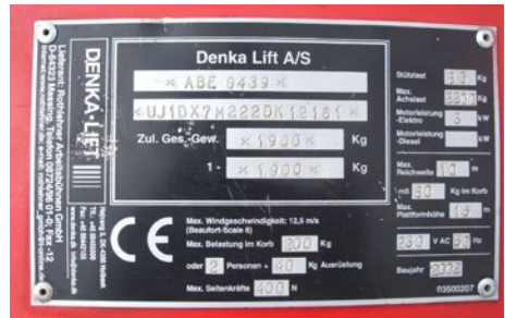
Bild 4-1 Fabrikschild mit CE-Kennzeichnung
