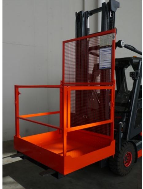
Abb. 3 Arbeitsbühne am Gabelstapler
