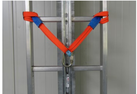
Abb. 23 Anschlag an einer Steigleiter mit Seitenholmen durch beidseitiges Umschlingen der Leiterholme über einer Leitersprosse
