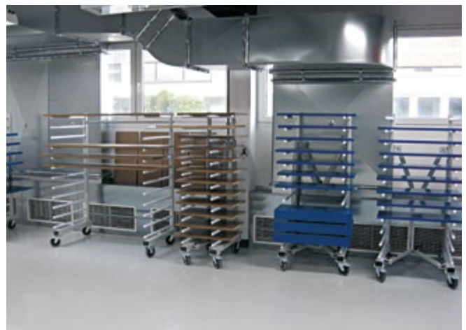
Abb. 2 Hordenwagen im Abdunst- und Trocknungsraum
