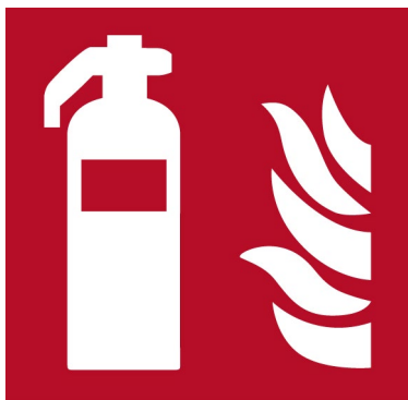
Abb. 17 Kennzeichnung F001 Feuerlöscher
