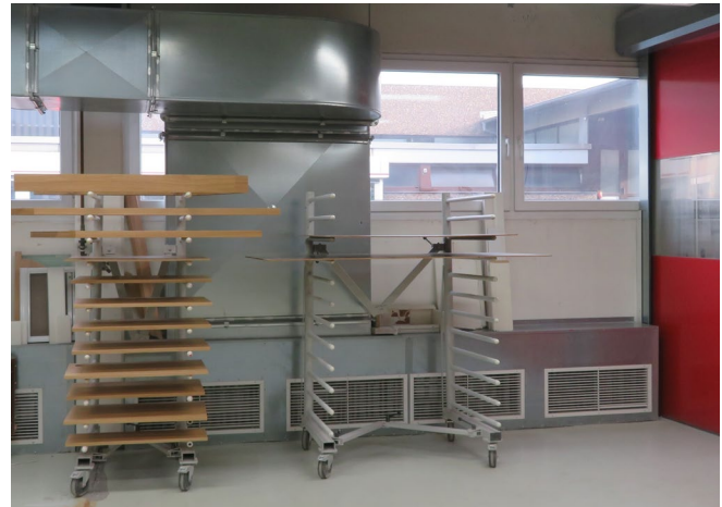
Abb. 49 Hordenwagen im Abdunst- und Ablüftungsbereich
