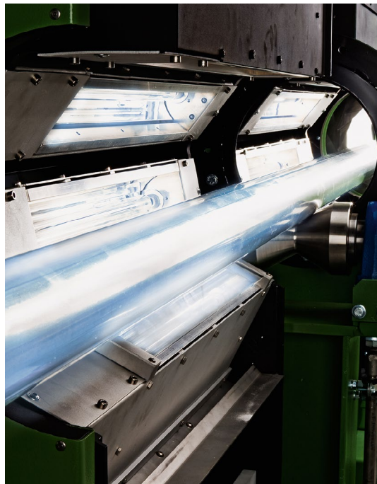
Abb. 3 UV-Härtung von beschichteten Rohren
