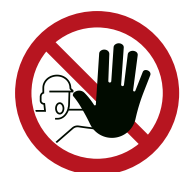
Abb. 26 Zutritt für Unbefugte verboten (P006)
