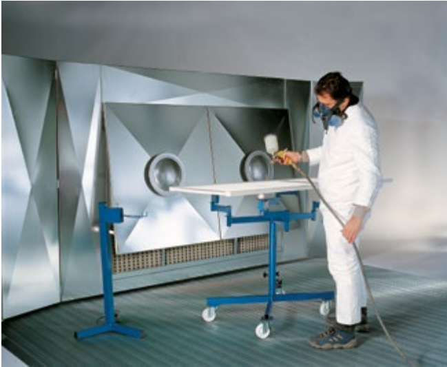
Abb. 28 Spritzstand mit Prallblech
