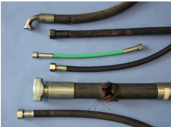
Abb. 16 Beispiele ausgefallener Hydraulik- Schlauchleitungen
