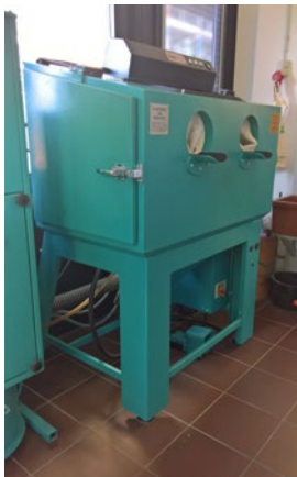
Stoffquelle vollständig eingehaust
