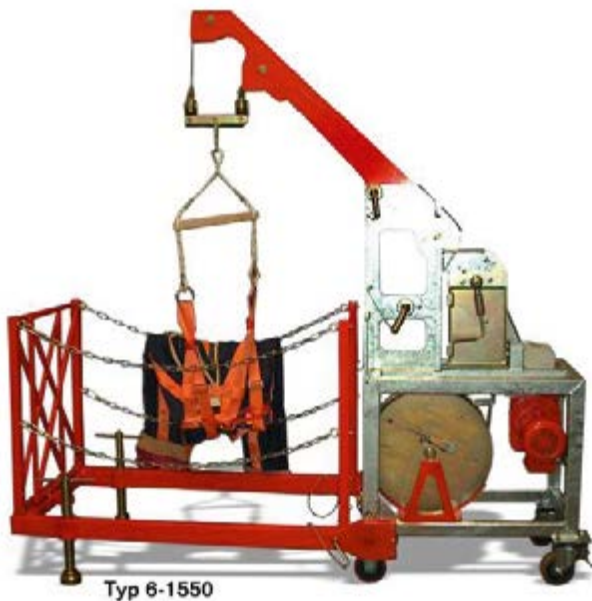
Abb. 8.11 Aufbau einer Siloeinfahreinrichtung
