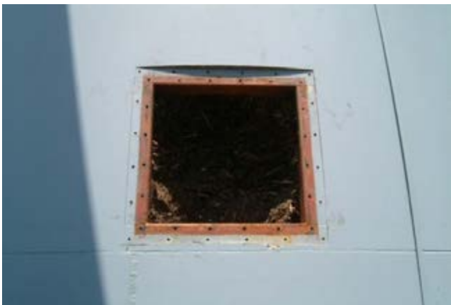
Abb. 8.9 Vorgefertigte Öffnung für den Einsatz eines Notentleerungssystems
