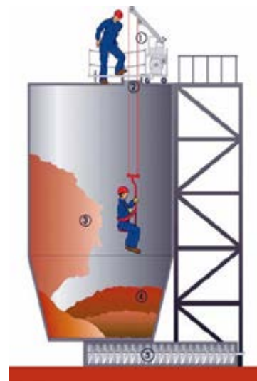
Abb. 7.14 Prinzip-Skizze zum Befahren eines Silos
