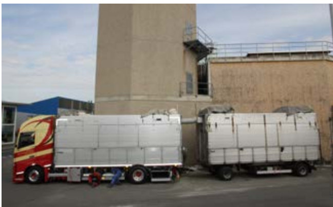
Abb. 7.9 LKW mit eigener Absauganlage
