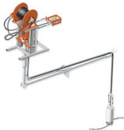
Abb. 8.4 Gelenkarm mit pneumatisch betriebenen Rotationsmotor
