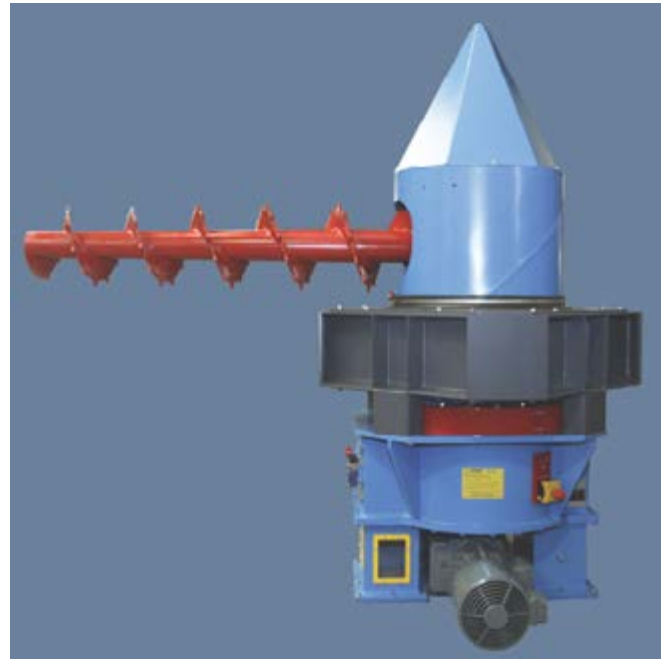
Abb. 8.10 Siloaustragung mit zwei Entnahmestutzen
