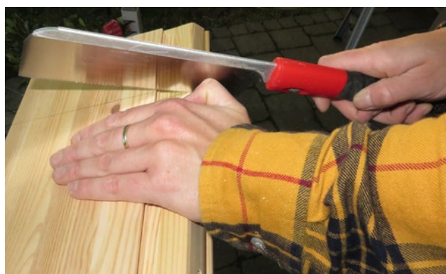
Abb. 47 Führen eines Sägeblatts beim Anschnitt
