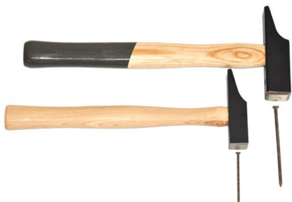
Abb. 16 Hammerkopf passend zur Nagelgröße
