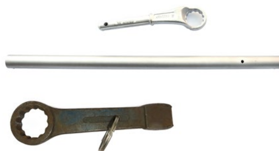
Abb. 29 oben: Zugringschlüssel mit Aufsteckrohr, unten: Schlag-Ringschlüssel
