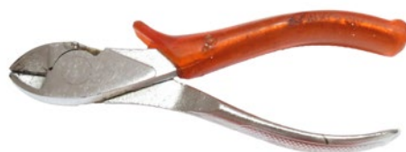
Abb. 39 Seitenschneider einsatzfähig: von weichem Draht bis Federstahl
