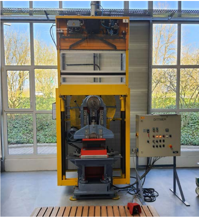
Abb. 22 (Hochbewegte) BA/„Schutzschirm“ an Exzenterpresse
