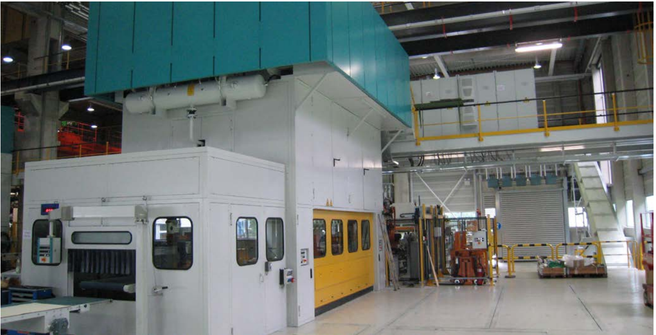
Abb. 23 (Hochbewegte) BA/„Schutzschirm“ an Exzenterpresse
