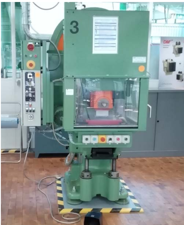
Abb. 21 SWZ an Exzenterpresse
