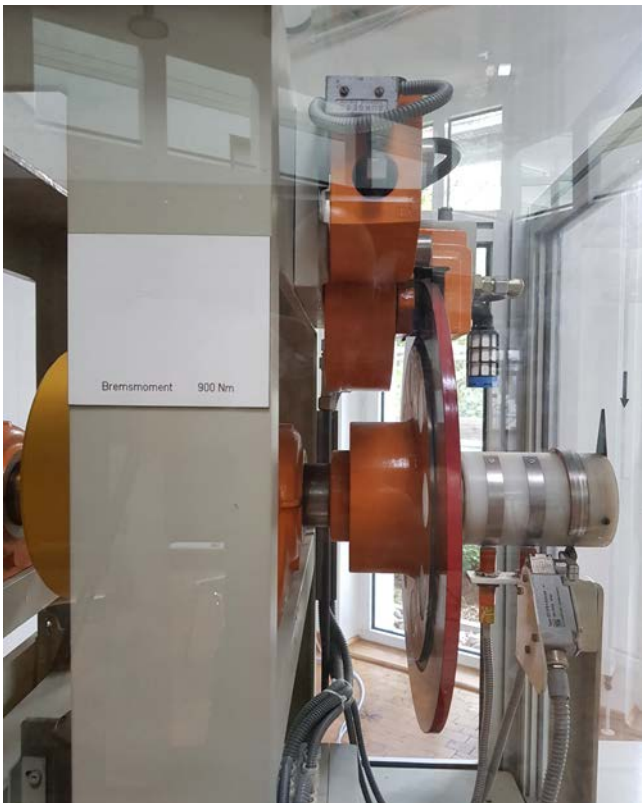
Abb. 15 Durchlaufsicherung (in Form einer Zusatzbremse)
