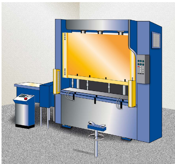
Abb. 5 Hydraulische Presse, Antrieb
