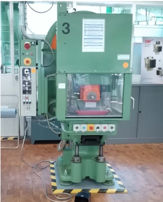
Abb. 21 BA „Schutzschirm“ an Exzenterpresse
