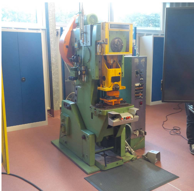
Abb. 27 ZHS an Exzenterpresse
