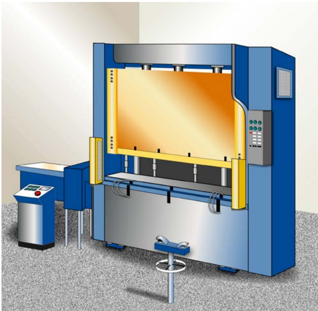
Abb. 5 Hydraulische Presse, Antrieb
