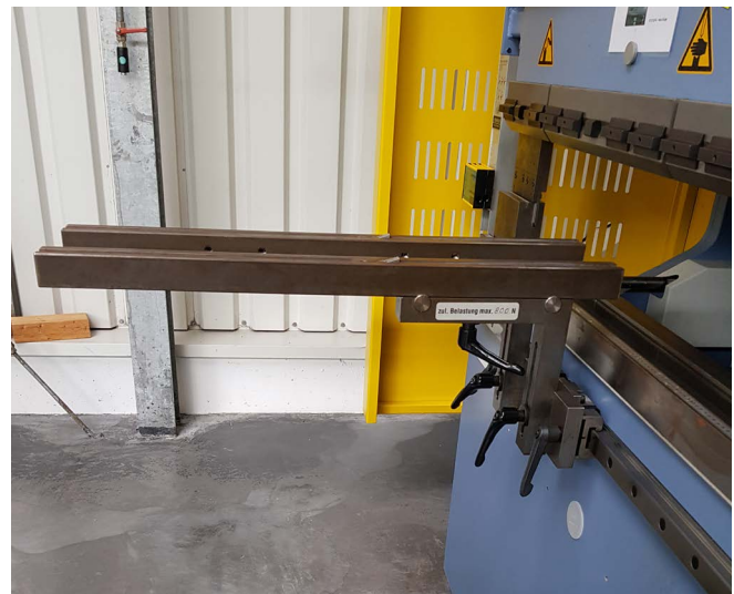
Abb. 41 Werkstückauflagen an Gesenkbiegepresse
