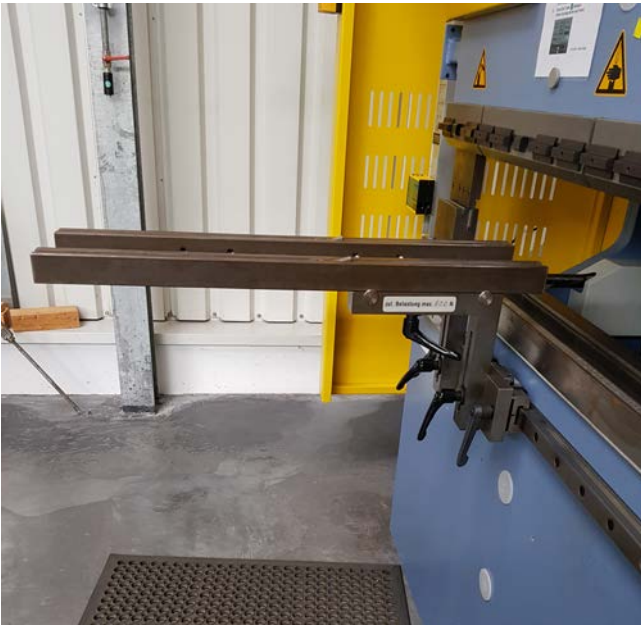
Abb. 40 Werkstückauflagen an Gesenkbiegepresse
