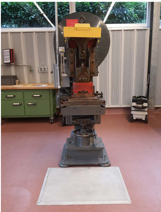
Abb. 19 SWZ an Exzenterpresse
