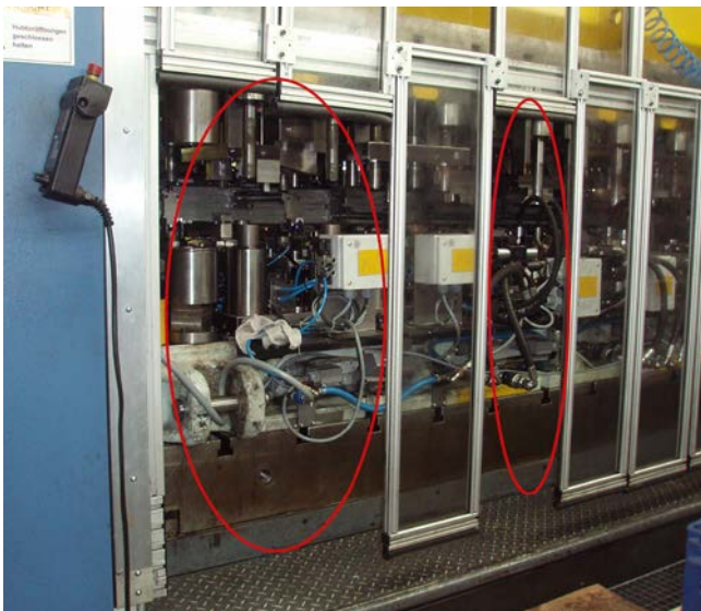
Abb. 36 Hubtor mit Schutzsegmenten
