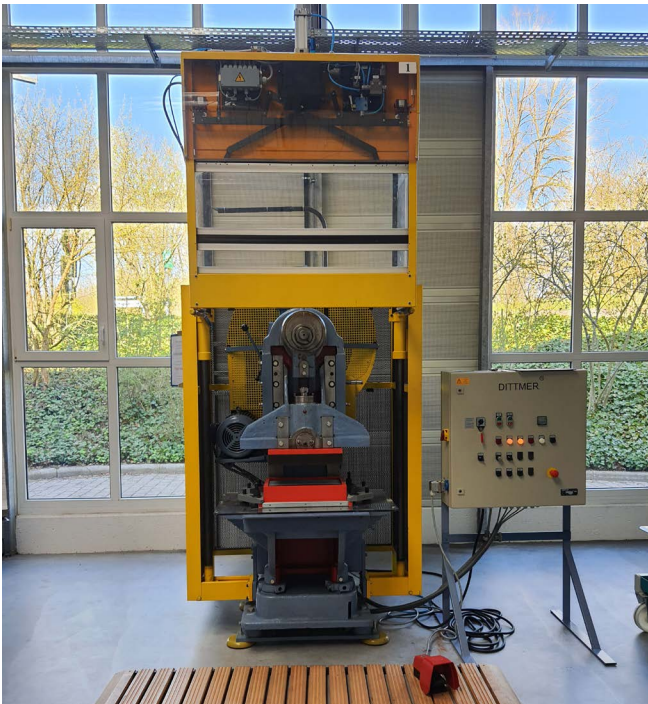
Abb. 22 (Hochbewegte) BA/ „Schutzschirm“ an Exzenterpresse
