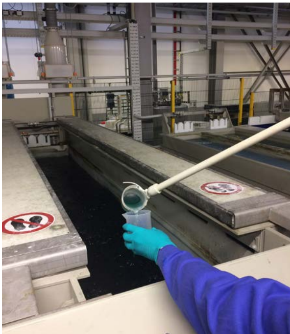
Abb. 8.1 Probeentnahme am Prozessbehälter mit geeignetem Hilfsmittel
