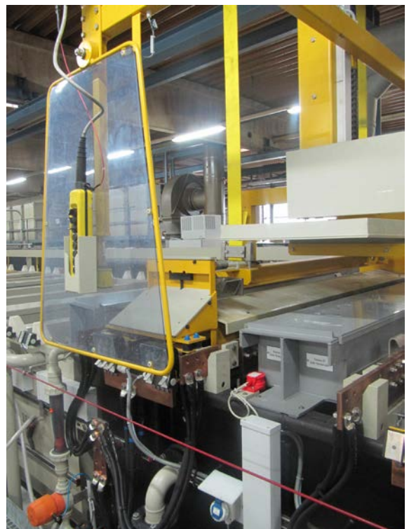
Abb. 2.8 Anfahrbügel mit Abdeckplatte am Transportwagen
