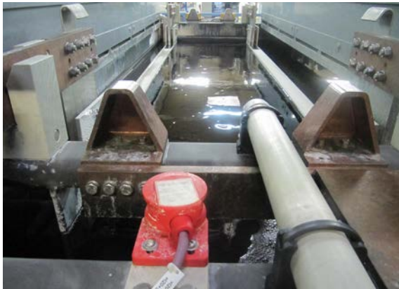
Abb. 4.1 Prozessbehälter mit Randabsaugung
