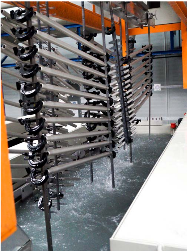
Abb. 1 Eine moderne Eloxalanlage für Aluminium-Bauteile
