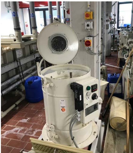
Abb. 12.1 Zentrifuge – ein Beispiel für prüfpflichtige Betriebseinrichtungen
