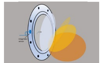
Öffnungsprinzip einer Berstscheibe
