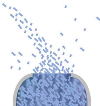
Räumliche Emission: Raum beim Spritzverzinken
