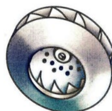
Abb. 3.4.6 Bauformen von Ventilator-Laufrädern
