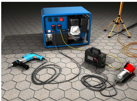
Abb. 5 Beispiel für den Betrieb eines Stromerzeugers bei erhöhter elektrischer Gefährdung
