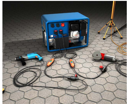
Abb. 3 Betrieb sämtlicher Betriebsmittel über jeweils eine PRCD
