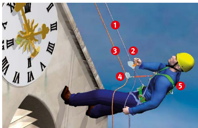
Zugangs- und Arbeitsplatzpositionierungssystem auf geneigter oder senkrechter Fläche
