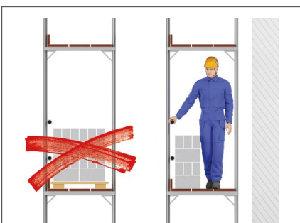
Bei Materiallagerung ausreichend breiten Durchgang auf dem Belag freilassen
