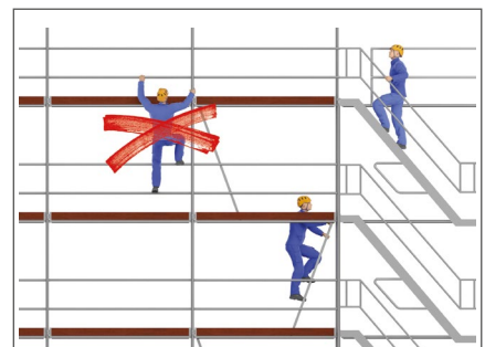
Zum Auf- und Abstieg nur vorhandene Leitern oder Treppen benutzen
