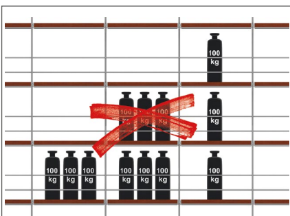
Gerüstbeläge nicht überlasten
