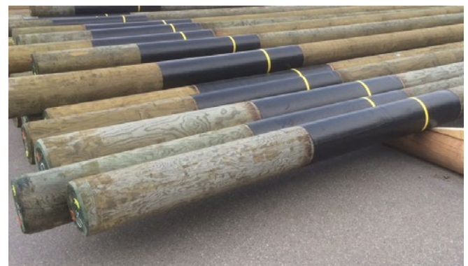
Abb. 5.4.2 Beispiel für die Ausstattung von Holzmasten mit PE-Schrumpfschlauch und innenliegender Messingfolie
