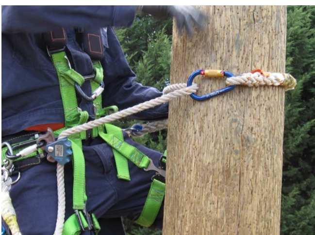
Abb. 7.8.1.1 Persönliche Schutzausrüstung zum Besteigen von und Arbeiten auf Holzmasten bestehend aus Auffanggurt, Halteseil mit Längeneinstellung und Klemmseil
