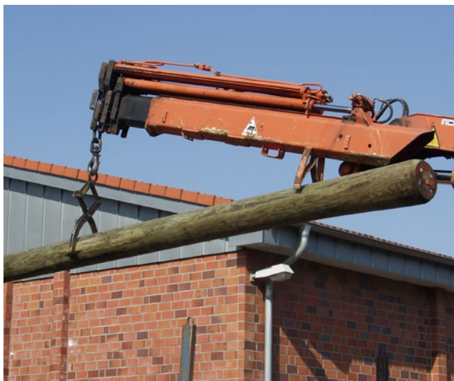
Abb. 4.1.2 Beispiel für eine Ausführung eines Ladearms mit nachgerüstetem Gegenlager
