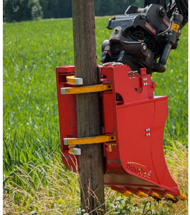
Abb. 7.6.5 Beim Einsatz hydraulischer Greifer kann auf Mastfußsicherungen verzichtet werden.
