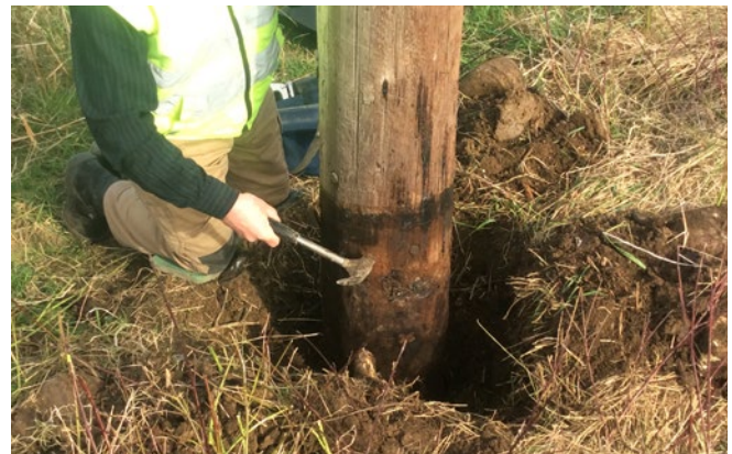
Abb. 7.4.5.1.b Das Abklopfen erfolgt auch im Bereich unter Erdgleiche am freigegebenen Mastabschnitt.
