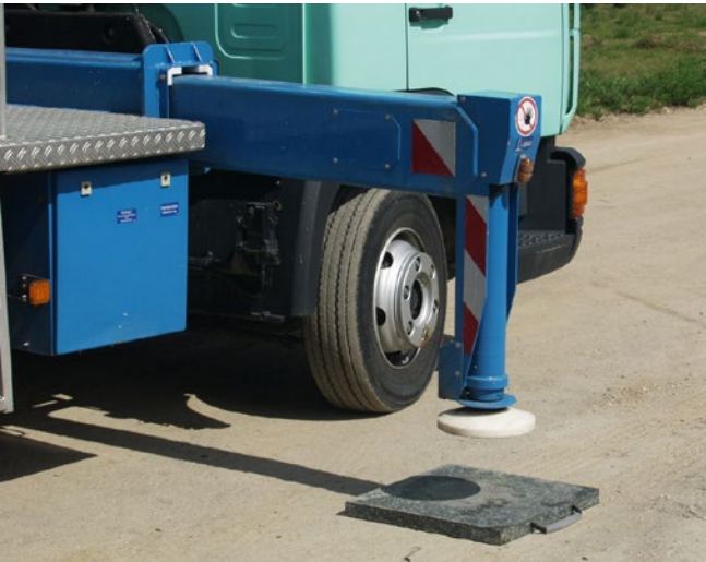
Abb. 4.1.5 Lkw-Stütze mit Unterlegplatte und Aufnahmevorrichtung am Lkw
