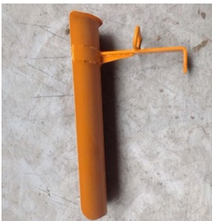
Abb. 5.2.2.2 Mastabgleiter zum Stellen von Holzmasten in Mastlöchern
