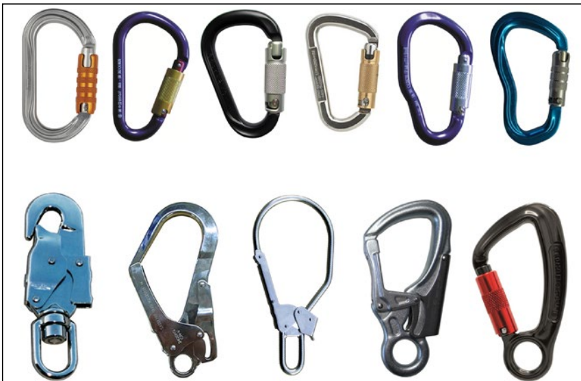
Abb. 56 Unterschiedliche Bauformen von Karabinerhaken mit zwei- oder dreifach automatisch wirkenden Verschlussicherungen.
