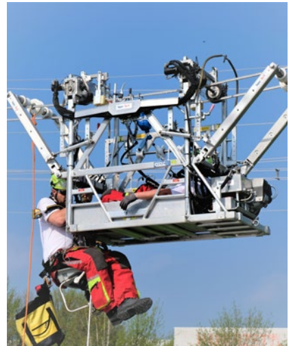
Abb. 137 Beispiel für einen kraftbetriebenen Befahrsitz, mit dem der Retter am vertikalen Seil zum Leitungsfahrzeug hinauf fahren kann.
