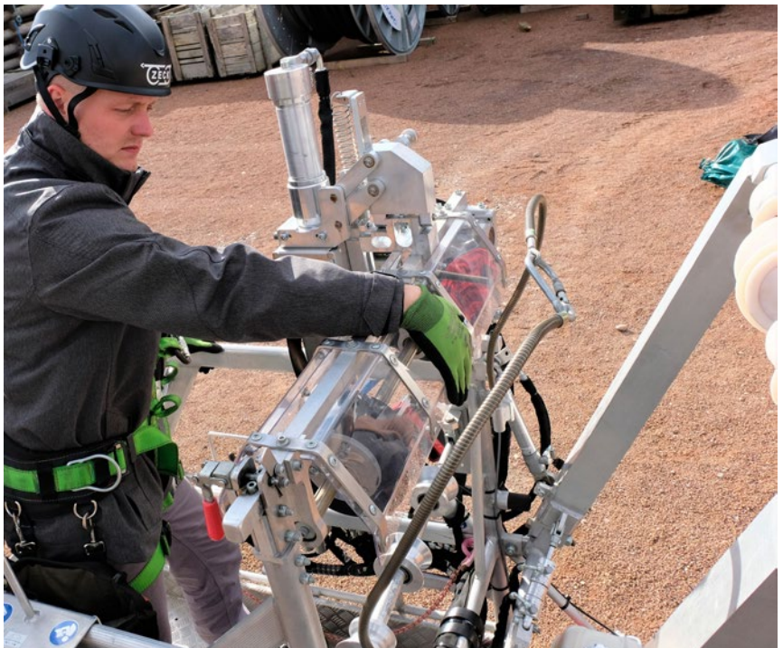
Abb. 130 Beispiel für eine Abdeckung bewegter Maschinenteile eines Leitungsfahrzeugs.
