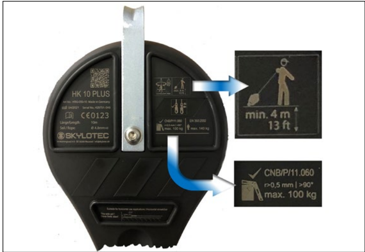
Abb. 55 Beispiel für die Kennzeichnung eines HSG mit Angaben für die horizontale Anwendung und Hinweisen zur Gefährdung durch scharfe Kanten. Weitergehende Hinweise sind der Gebrauchsanleitung des jeweiligen Herstellers zu entnehmen.
