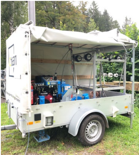
Abb. 133 Beispiel für einen Rettungsanhänger mit vollständiger Ausrüstung für Rettungseinsätze an Leitungsfahrzeugen. Enthalten sind z. B. Seilwinde, Rettungsfahrwagen, Strickleiter, Erdungsstange mit Erdungsgarnitur.
