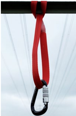
Abb. 57 Bandschleife zur Schaffung eines Anschlagpunktes nach DIN EN 795. Im Ankerstich befestigte Anschlagmittel verlieren mit dieser Befestigungsweise einen erheblichen Teil ihrer Tragfähigkeit. Nähere Angaben sind der Gebrauchsanleitung des Herstellers zu entnehmen.
