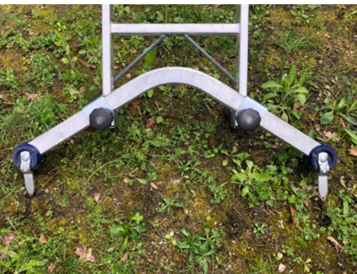
Abb. 154 Einsatz von Anlegeleitern mit justierbarer Fußtraverse und Erdspießen zum Nivellierungsausgleich (auch als Nachrüst-satz erhältlich).
