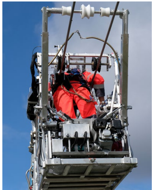
Abb. 124 Beispiel für ein eingehängtes Leitungsfahrzeug mit geschlossenen Sicherungseinrichtungen gegen Abstürzen des Fahrzeugs.
