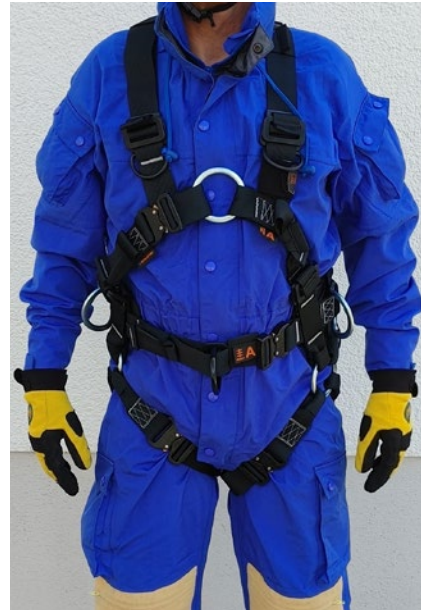
Abb. 32 Beispiel für einen Auffanggurt nach DIN EN 361 mit vorderer Auffangöse und zusätzlicher Auffangöse in Steigschutzposition. Der Bauchgurt ist mit zwei seitlichen Halteösen ausgestattet.
