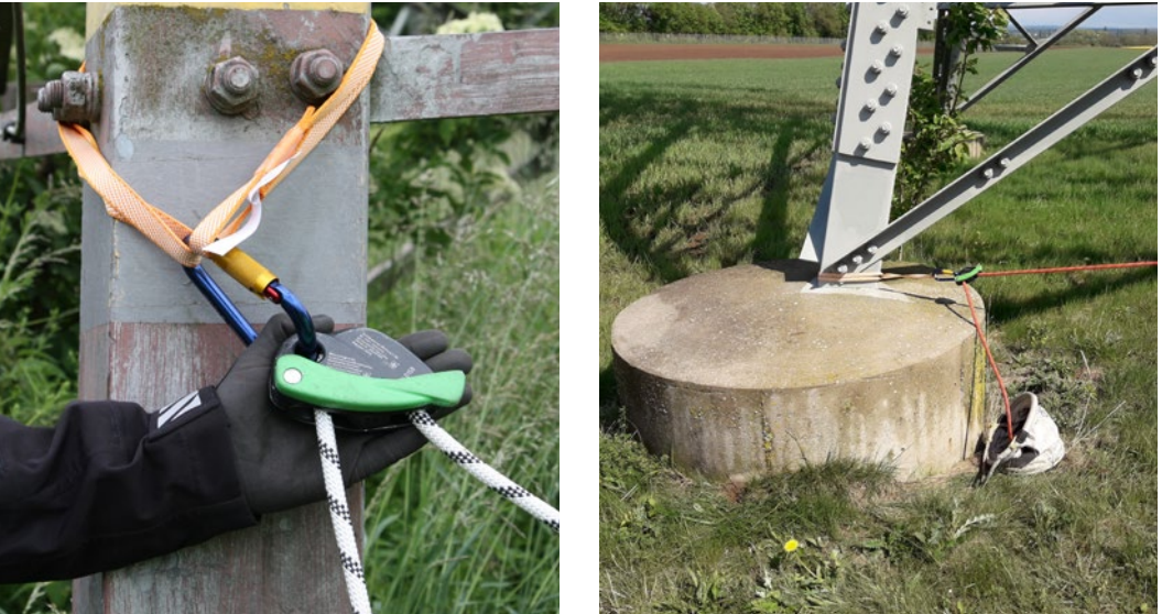
Abb. 68 Beispiel für ein am Mastfuß installiertes Sicherungsseil mit Seilbremse. Das Seil wird entsprechend dem Aufstieg aus dem Transportsack nachgeführt.
