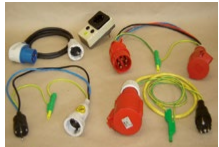
Abb. 7.2 Verschiedene Prüfadapter, u. a. zum Anschluss von Drehstrom-Prüflingen sowie zur Schutzleiter- und Berührungsstrommessung.
