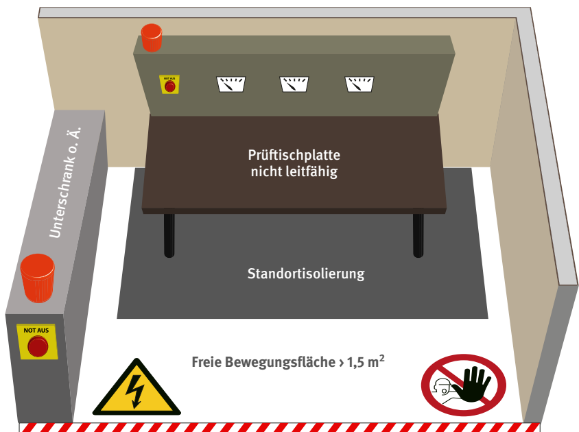
Abb. 6.1 Beispiel für einen Prüfplatz in einer Elektrowerkstatt.
