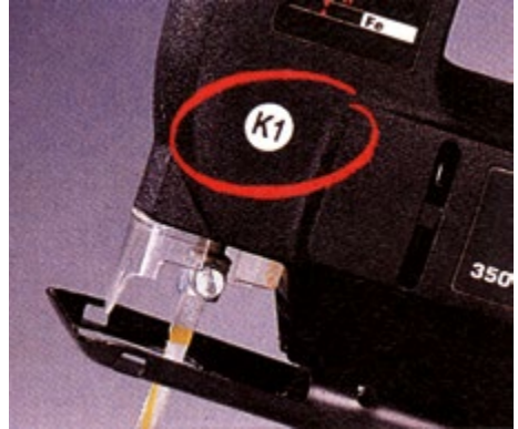
Abb. 8.1 Kennzeichnung der Anwendungskategorie am Betriebsmittel, hier K 1
