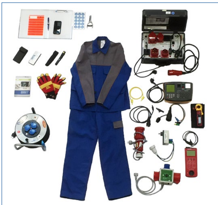
Abb. 4 Beispiel möglicher Ausstattung für die Prüfung ortsveränderlicher elektrischer Betriebsmittel
