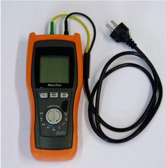
Abb. 35 Kompaktes Prüfgerät für Messungen an elektrischen Anlagen und Betriebsmitteln (ohne Speicher oder Schnittstelle)
