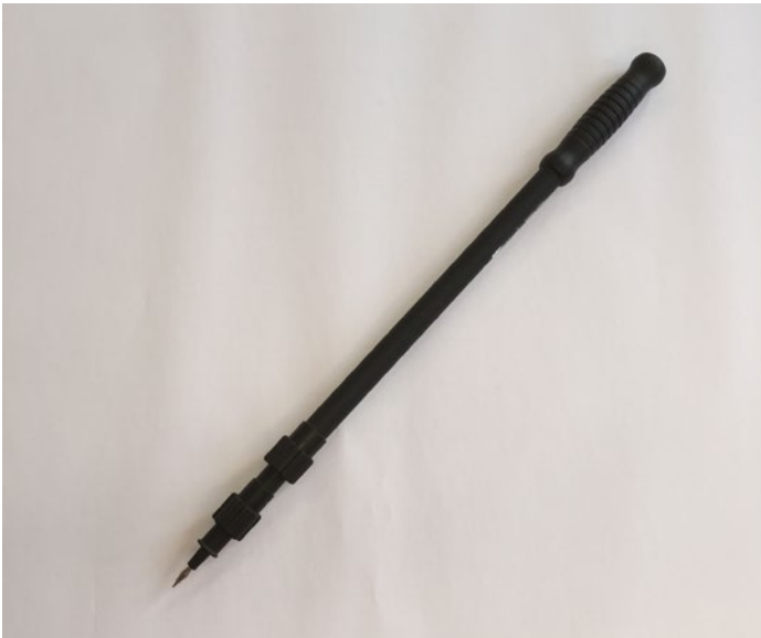
Abb. 44 Teleskopstab als Prüfspitzenverlänge- rung für die Schutz- leiterwiderstands- messung an Leuch- ten und sonstigen schwer erreichbaren Betriebsmitteln
