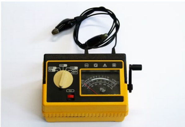
Abb. 28 Prüfgerät zur Ermittlung des Schutzleiter- und Isolationswiderstandes mit Analoganzeige. Prüfspannung wird über Drehkurbel erzeugt.
