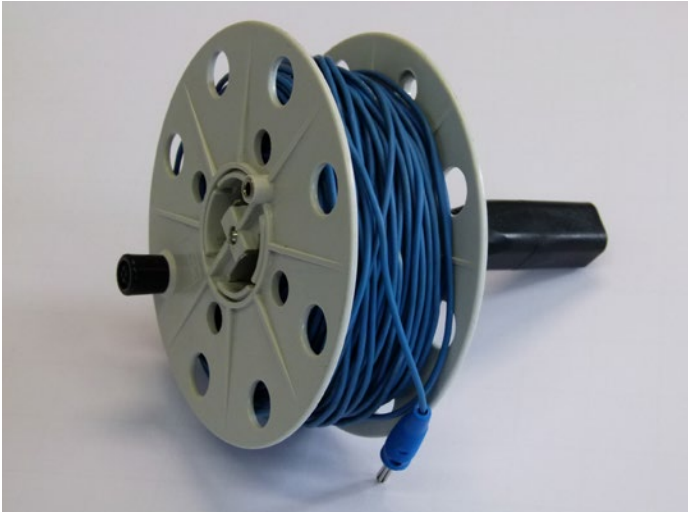
Abb. 45 Lange Messleitung auf Spindel für Schutzleiterwider- standsmessungen
