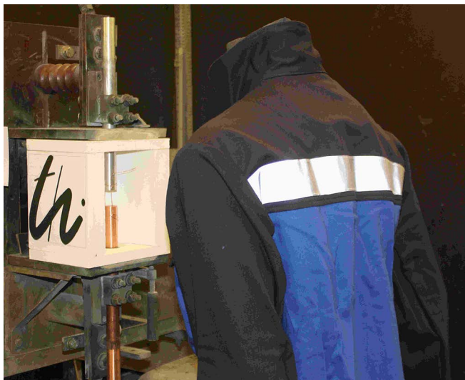
Abb. A 2-1 Prüfaufbau Box-Test Verfahren
