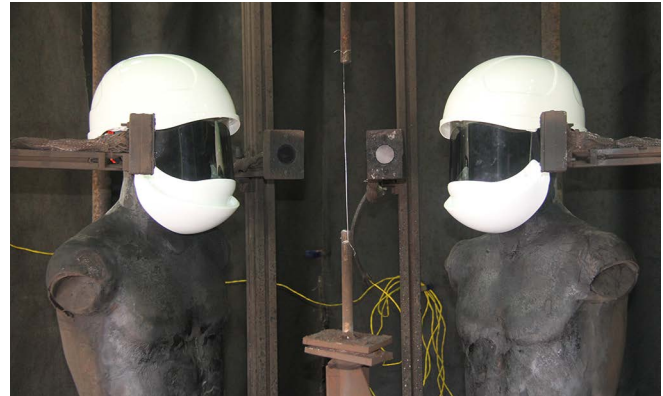
Abb. A 2-2 ATPV-Testaufbau
