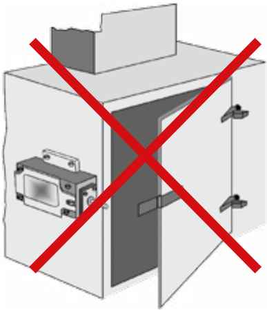
Abb. 33 Unzulässige Anbringung eines Positionsschalters Bauart 1
