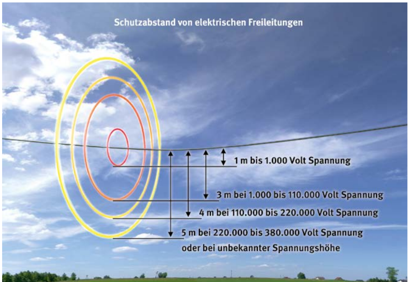
Abb. 23 Schutzabstände, hier z. B. bei einer Freileitung
