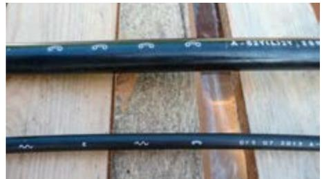
Abb. 8 Kupferkabel (oben) und Glasfaserkabel
