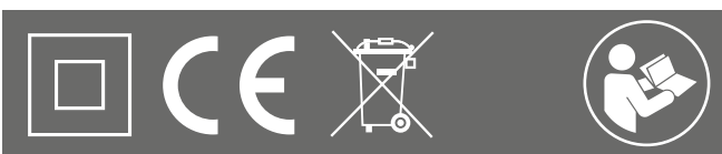
Abb. 19 Typenschild mit Symbol Schutzklasse II → Schutzisolierung
