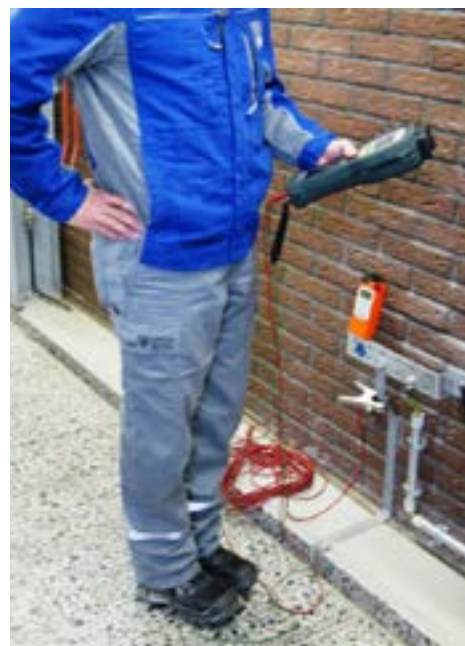
Abb. 35 Durchführung der Fußbodenmessung
