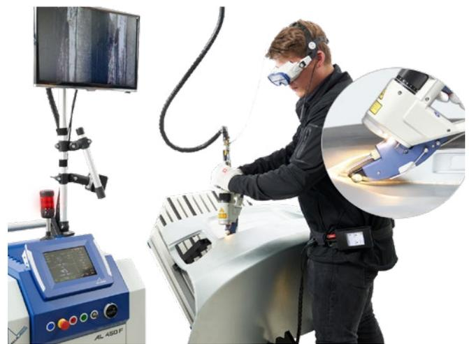
Abb. 3 Offenes handgeführtes Laserbearbeitungsgerät
