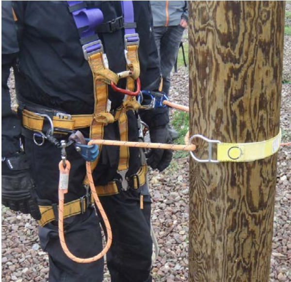
Abb. 2 Beispiel einer Persönlichen Schutzausrüstung zum Besteigen von und Arbeiten auf Holzmasten bestehend aus Auffanggurt, Halteseil mit Seilkürzer und Klemmseil
