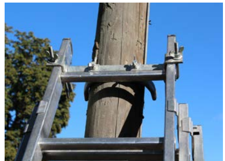
Abb. 30 Abrutschsicherung für den Einsatz von Anlegeleitern an Holzmasten
