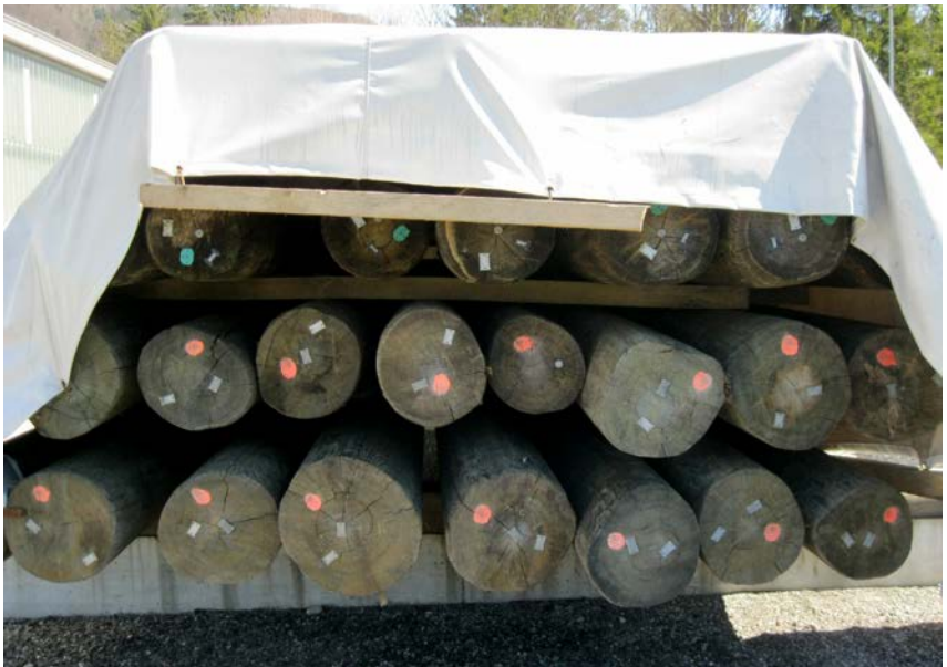
Abb. 9 Beispielhafte Lagerung von Holzmasten mit Abdeckung zum Schutz vor Witterungseinflüssen
