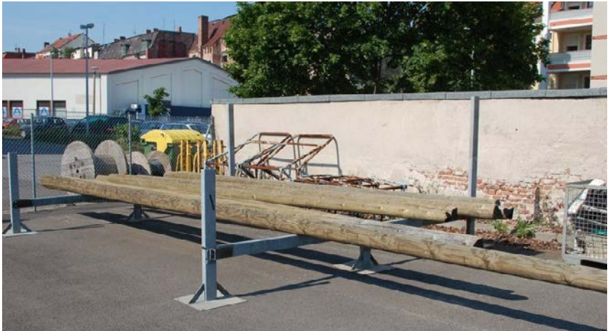
Abb. 10 Zum Schutz vor Bodenfeuchtigkeit hat sich z. B. eine Lagerung von Masten auf Gestellen bewährt
