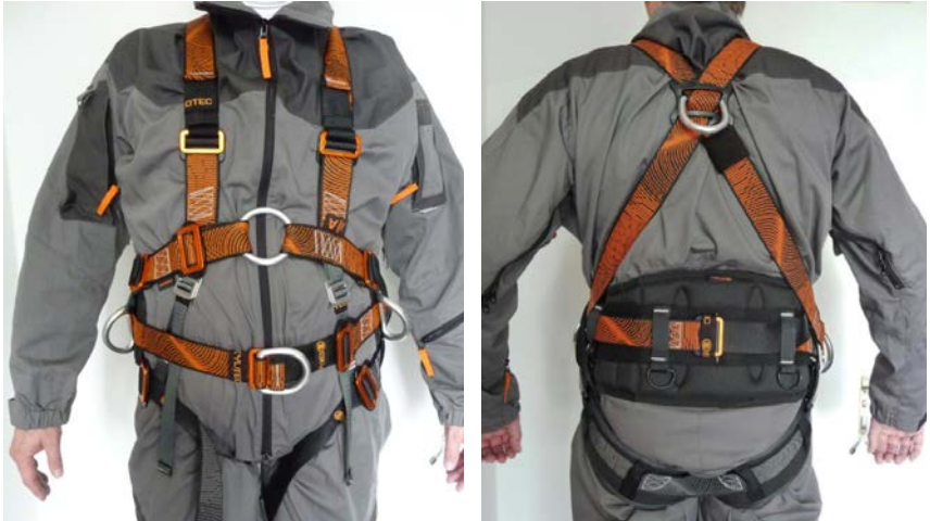
Abb. 1 Beispiel für einen zum Besteigen von und Arbeiten auf Holzmasten geeigneten Auffanggurt
