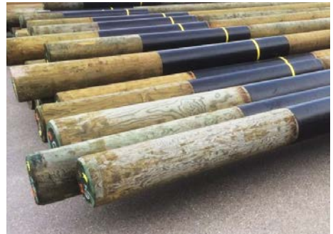
Abb. 17 Beispiel für die Ausstattung von Holzmasten mit PE-Schrumpfschlauch und innenliegender Messingfolie
