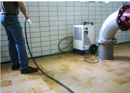
**Abb. 11** Strahlwassereinwirkung auf Anschlussleitung und Betriebsmittel
