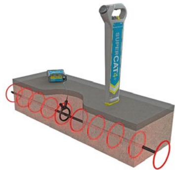
Abb. 7 Indirekte (induktive) Einkopplung eines Signals
