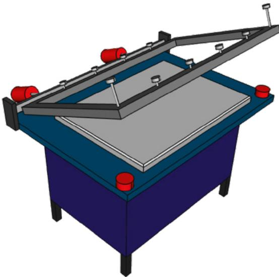
Abb. 1 Winkelöffnender Handdrucktisch
