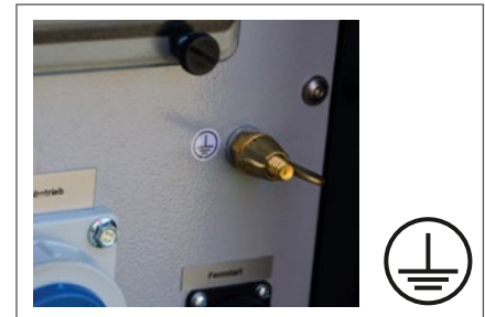
Abb. 2 Symbol 5019 „Schutzerdung“ nach DIN IEC 60417
