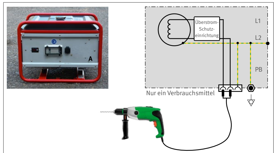
Abb. 6 Stromerzeuger ohne Erdungsanschluss mit nur einer Steckdose und nur einem angeschlossenen Verbrauchsmittel
