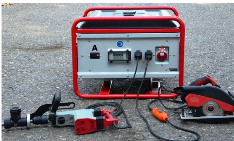
Abb. 21 Zwei Betriebsmittel – Abbruchhammer direkt angeschlossen, Säge mit zwischengeschalteter PRCD
