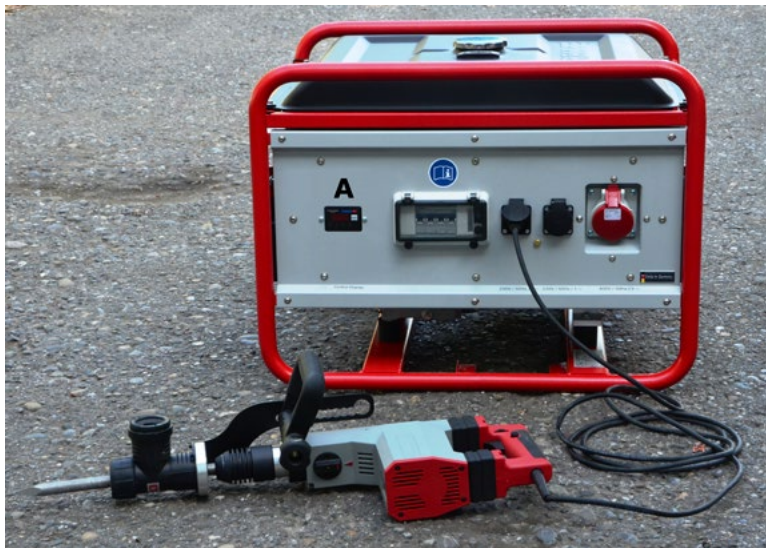
Abb. 20 Ein Betriebsmittel angeschlossen ohne weitere Schutzmaßnahme
