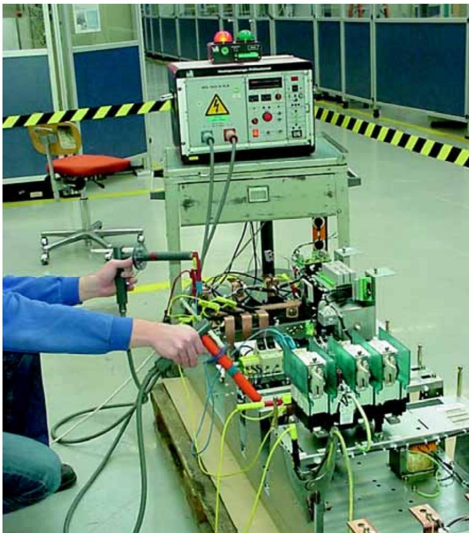
Bild 6: Prüfarbeiten unter Verwendung von Sicherheitsprüfspitzen
