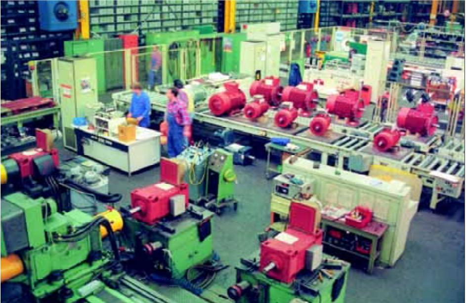
Bild 7: Motorenprüffeld
