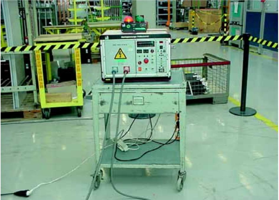
Bild 5: Durch Ausziehband abgegrenzter Prüfbereich für einen Prüfplatz ohne zwangsläufigen Berührungsschutz
