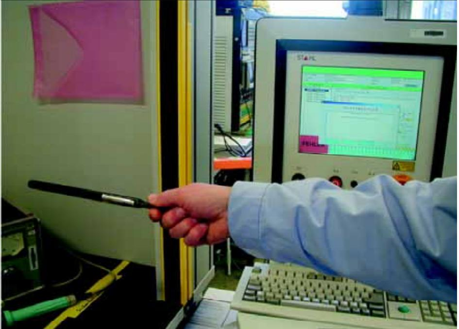
Bild 2: Funktionskontrolle der Sicherheitslichtschranke mittels Prüfstab
