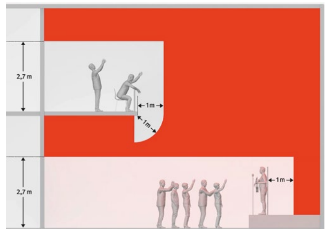
Abb. 3 Abgrenzung zwischen dem Zuschauerbereich und dem Showlaserbereich
