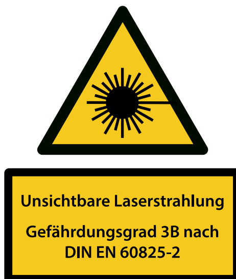
Abb. 8 Sicherheitskennzeichnung der Arbeitsbereiche je nach Gefährdungsgrad und Zugang
