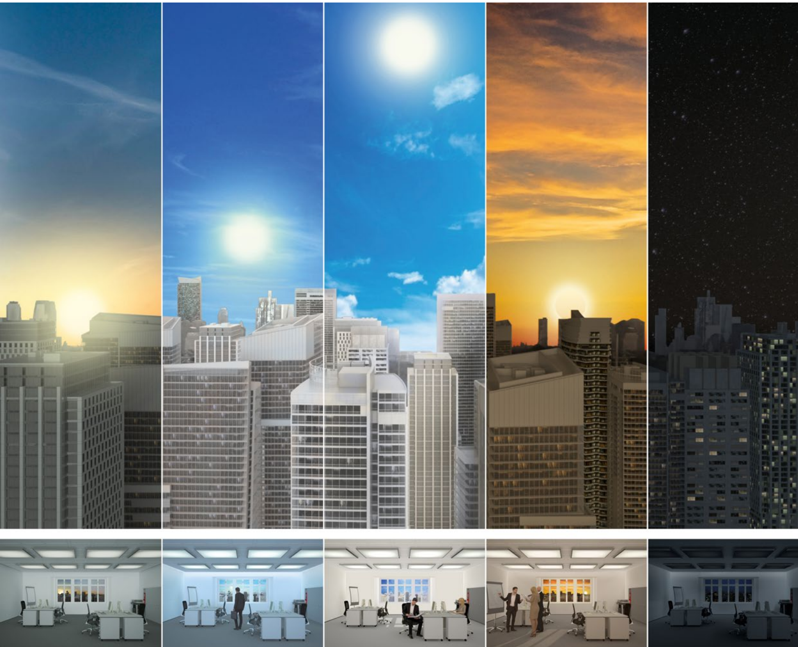
Abb. 12 Veränderung von Beleuchtungsstärken, Lichtspektrum und räumlicher Verteilung von Licht. Die künstliche Beleuchtung wird dem Tagesverlauf angepasst. Die hellen Wände und Decken sollen tagsüber durch indirekte Lichtanteile die nichtvisuellen Wirkungen verstärken. Am Abend ist die notwendige Helligkeit am Arbeitsplatz beschränkt. Der geringere indirekte Anteil des Lichts auf der Decke und den Wänden soll nichtvisuelle Wirkungen reduzieren.
