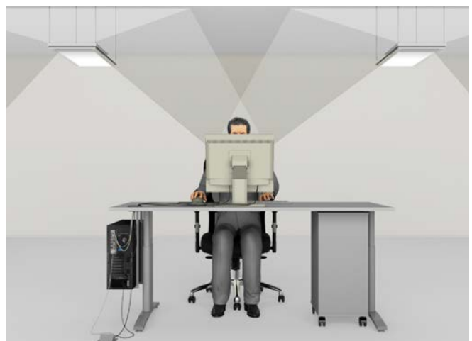
Abb. 45 Beispiel für Direkt-/Indirektbeleuchtung
