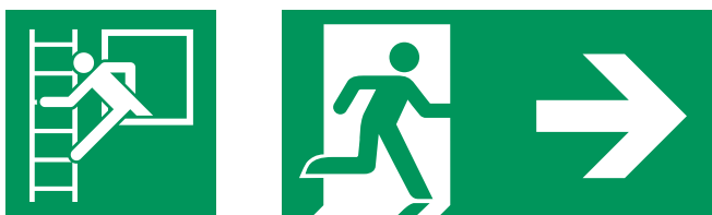
Abb. 12: Notausstieg mit Fluchtleiter und Rettungsweg/Notausgang mit Zusatzzeichen (ASR A1-3)
