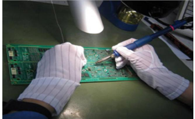
Abb. 1 Kolbenlöten mit Lötspitze, Lötendraht und Absaugung
