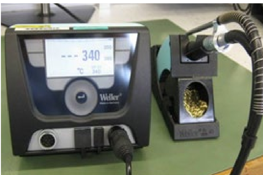
Abbildung 2 Bleifreies Kolbenlöten mit Lötspitze, Lötendraht und Absaugung
